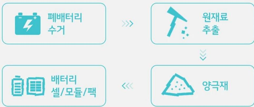
폐배터리를 재활용하기 위해서는 재사용이 불가능한 폐배터리를 분해하고 용해하는 과정을 거쳐야 합니다. 이를 통해 코발트, 니켈 등 배터리에 쓰이는 원자료를 추출합니다. 그리고, 이를 다시 양극재 생산 단계에 투입하여 새로운 배터리를 만드는 데 활용하는데요.
