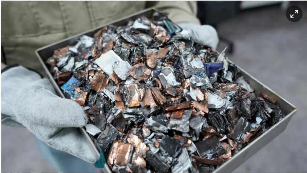
폐배터리에서 핵심 소재인 희소금속을 추출해 새 배터리 제작에 활용하는 폐배터리 재활용. 사진은 영풍 2차 전지 리사이클링 원료 'LiB Flake'의 모습(영풍 제공)/그린포스트코리아
